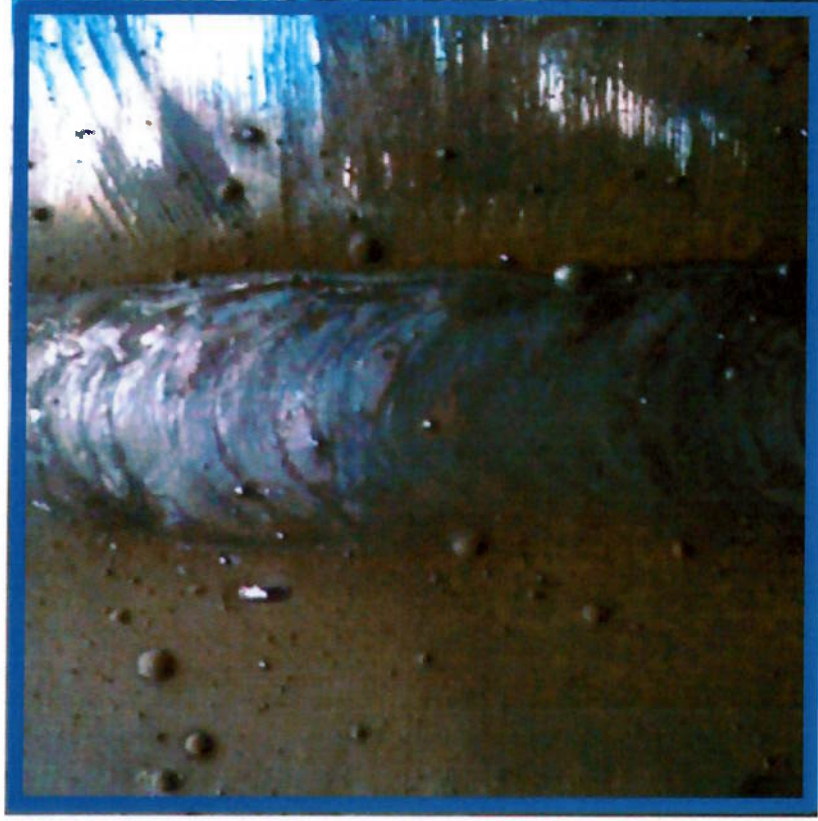
Figura 5-14 Passe com processo MIG/MAG curto-circuito (imagem referente a 100 cm 2 do CP1).
