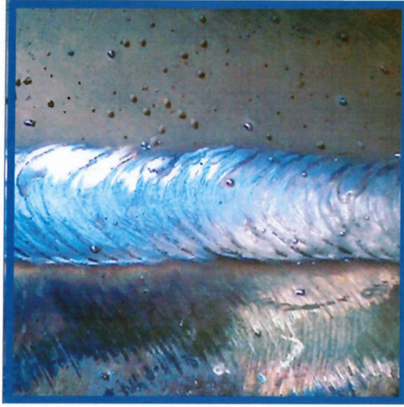
Figura 5-15 Passe com processo MIG/MAG projetada – pulsada (imagem referente a 100 cm 2 do CP5).
